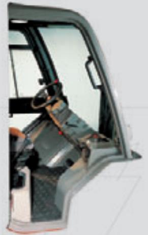
Un monolevier en croix, proche du siège, regroupe les fonctions d'élévation/descente et d'inclinaison du mât (10°/12°). Le MSI dispose d'un **système d'accélération automatique du mouvement de levée du mât**, indépendant de la translation.
